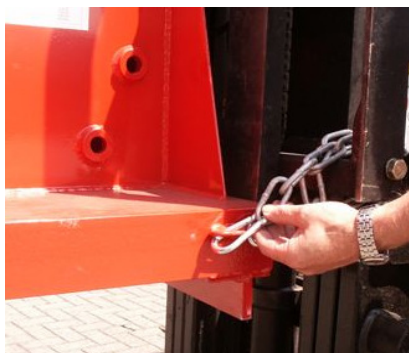
Afbeelding 10a: Ketting naar basismachine
