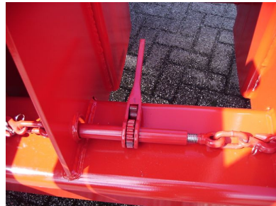
Afbeelding 16: Zet de load binders op spanning
